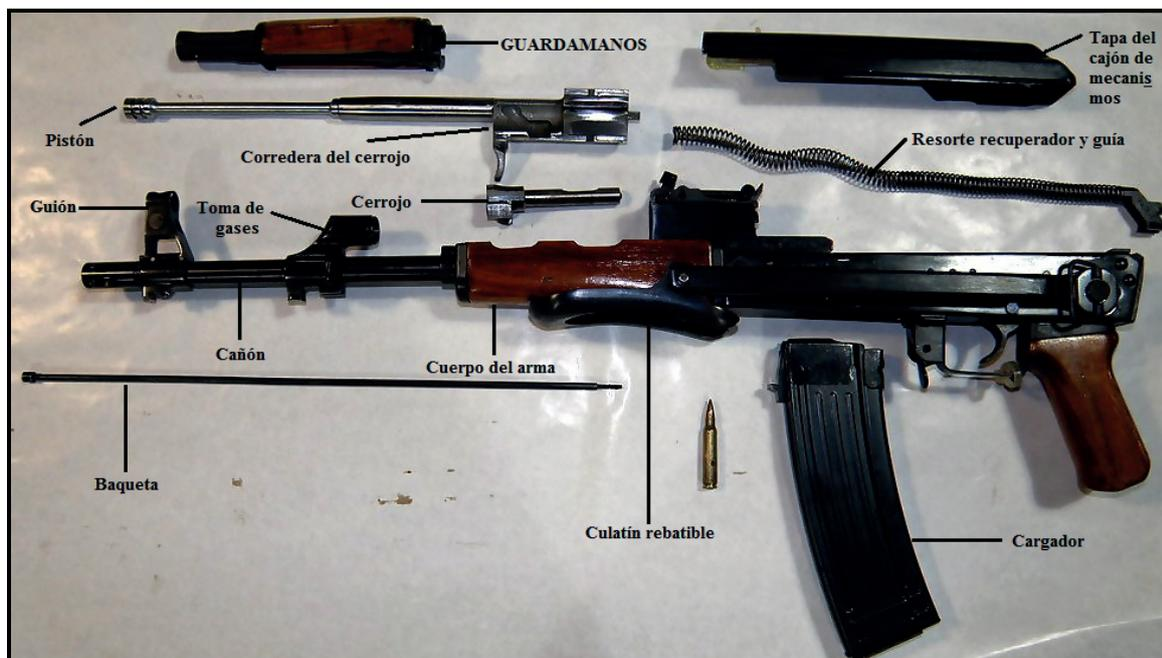
Presentamos a continuación un despiece del arma. Fotografía obtenida en ocasión de un TP sobre el AK-47 para la materia "ARMAS II" dictada en el tercer año de la carrera de Técnico Universitario en Balística y Armas Portátiles. (IUPFA 2016).
