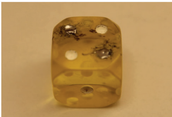
Figura N° 5: Dado indubitado cargado, se observa en el número cuatro la carga con plomo de los puntos diagonales.
