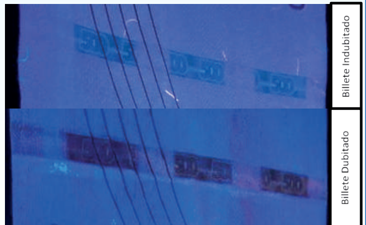
Hilos de seguridad en Billetes de 500 pesos de la familia G Fuente: Elaboración Propia, Luis Guillermo Ramírez (2020).
