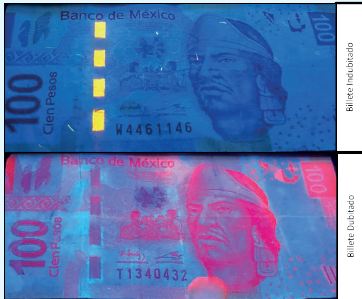
Análisis con luz de UV de billetes de cien pesos Fuente: Elaboración propia: Luis Guillermo Ramírez, 2020.
