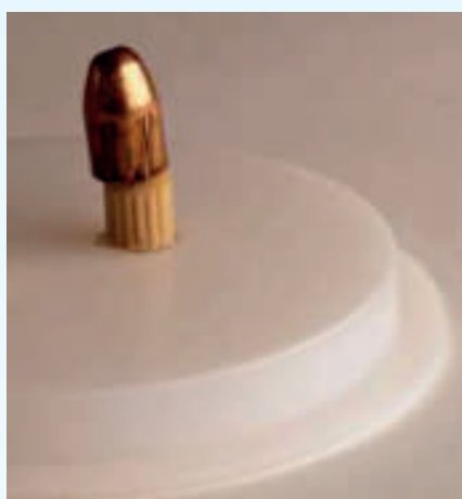
Figura N° 2. Montaje del proyectil a una base de plástico 18
