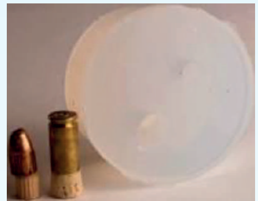
Figura N° 11. Molde en condiciones para iniciar el proceso de fundición de la resina 30
