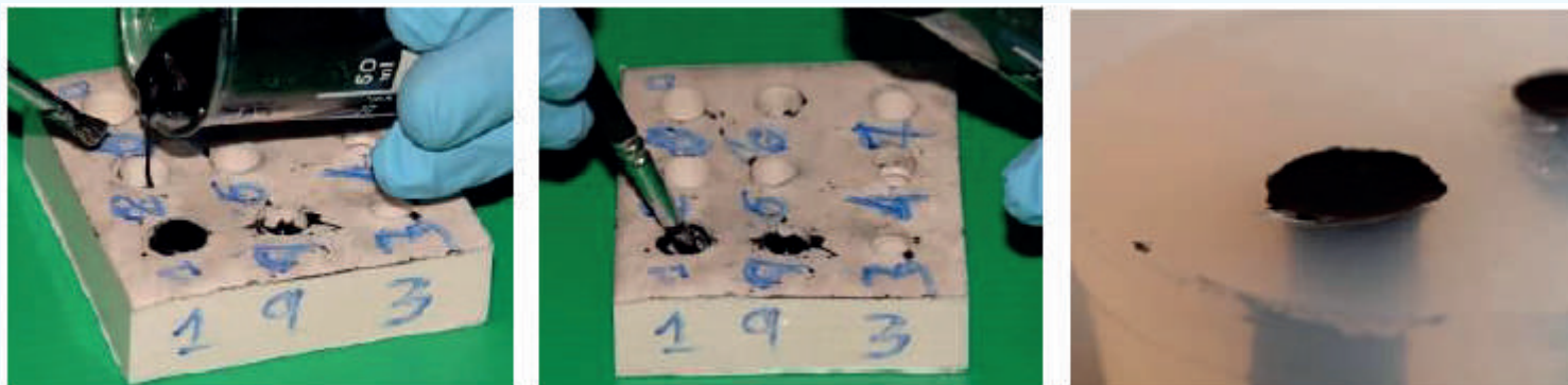
Figura N° 12. Introducción de la resina en la caja del molde 31
