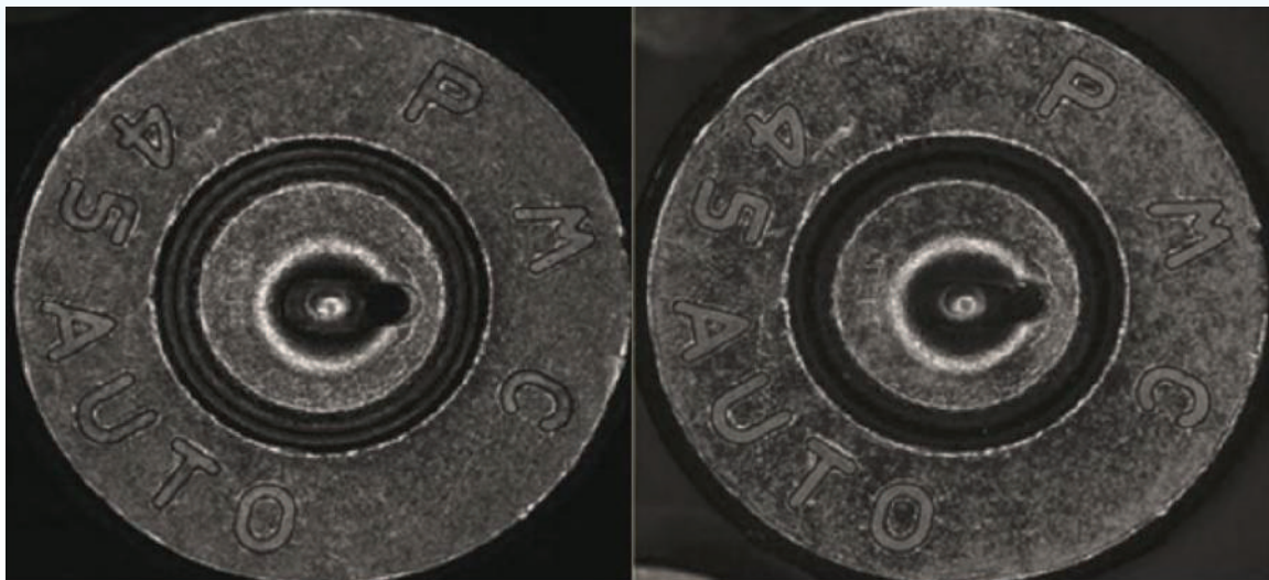
Figura N° 18. Vaina situada a la izquierda del observador: original. Vaina situada a la derecha: clonación. Ambas observadas a través del comparador de imágenes IBIS BrassTRAX- 3D 37
