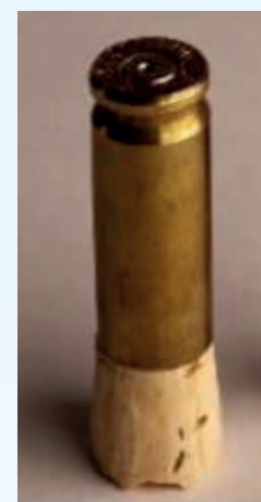
Figura N° 4. Acondicionamiento de la vaina, mediante la colocación de un tapón de corcho 21
