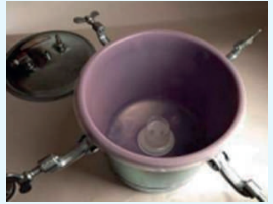
Figura N° 9. Introducción de la caja de molde en la olla de presión 28
