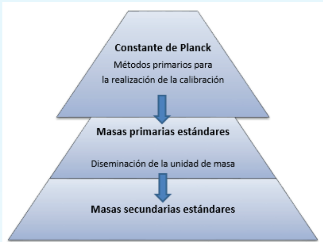
Fig. Nº 6. Esquema jerárquico de la cadena de trazabilidad (Adaptado de: Richard et al., 2016).
