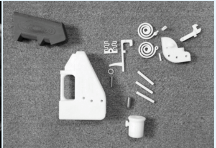
Fig. Nº 6. Piezas impresas del arma de fuego The Liberator, mediante el método FDM, fabricado por Cody Wilson y la compañía Defense Distributed, extraído de Thad M. para Forbes. Recuperado de https://www.forbes.com/sites/andygreenberg/2013/05/05/meet-the-liberator-test-firing-the-worlds-first-fully-3d-printed-gun/#4ae9ff8752d7 . Copyright©
