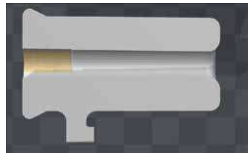
Fig. N° 14. Corte longitudinal, del interior del cañón donde se observa el área destinada como recámara.
