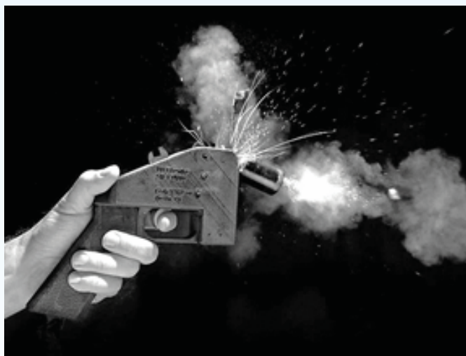
Fig. N° 8. Disparo de prueba realizado por el arma de fuego The Liberator, extraído de Clark R. prueba fallida del arma impresa, recuperado de http://ngm.nationalgeographic.com/2014/12/3d-printer/clark-photography#06-printed-gun-fail-to-fire-670 . Copyright©
