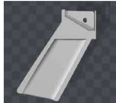
Fig. N° 20. Corte longitudinal de la empuñadura donde se observa su parte interna.
