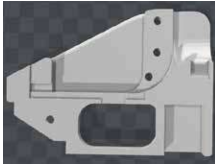
Fig. N° 16. Corte longitudinal de la caja de mecanismos donde se observa su diseño interno
