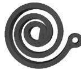
Fig. N° 26. Muelles del percutor
